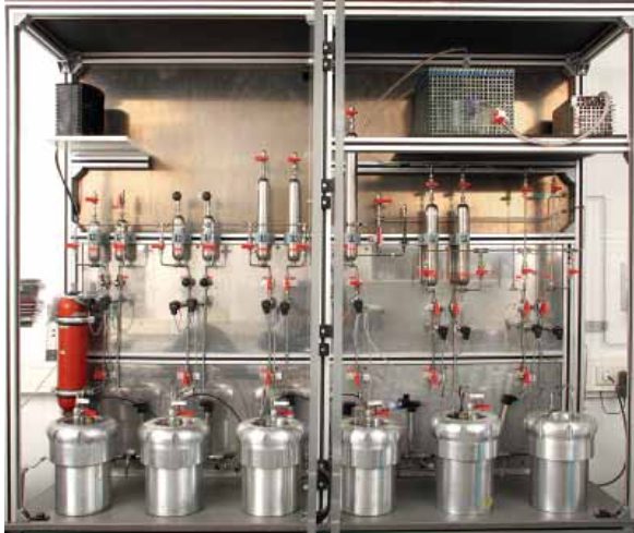
Messschrank für das instationäre Zweikammervorfahren mit sechs Messsträngen und unterschiedlichen Kammervolumina
